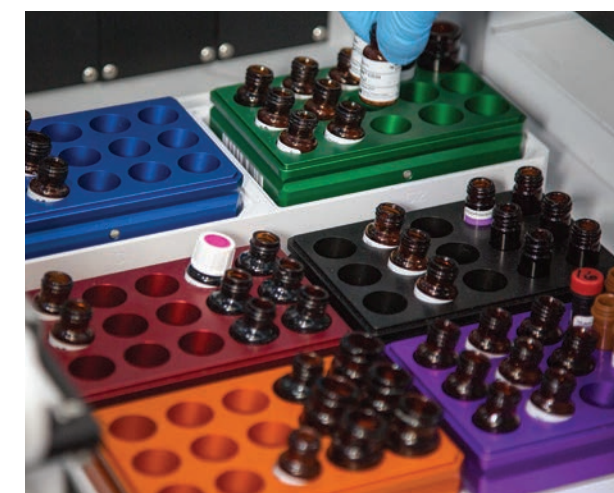
Les blocs réactifs du PS-10 peuvent contenir jusqu'à 90 flacons de différentes tailles
